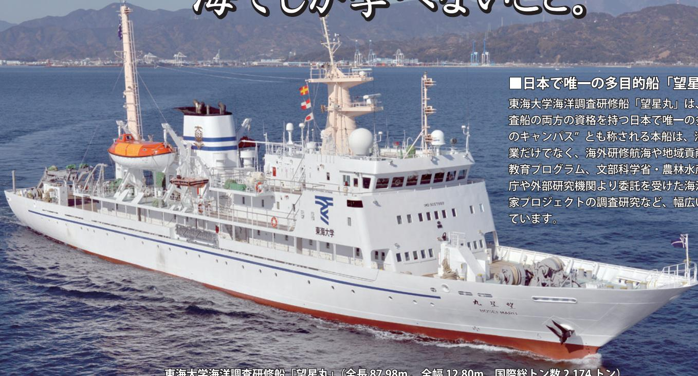
東海大学海洋調査研修船「望星丸」(全長 87.98m、全幅 12.80m、国際総トン数 2,174 トン)
